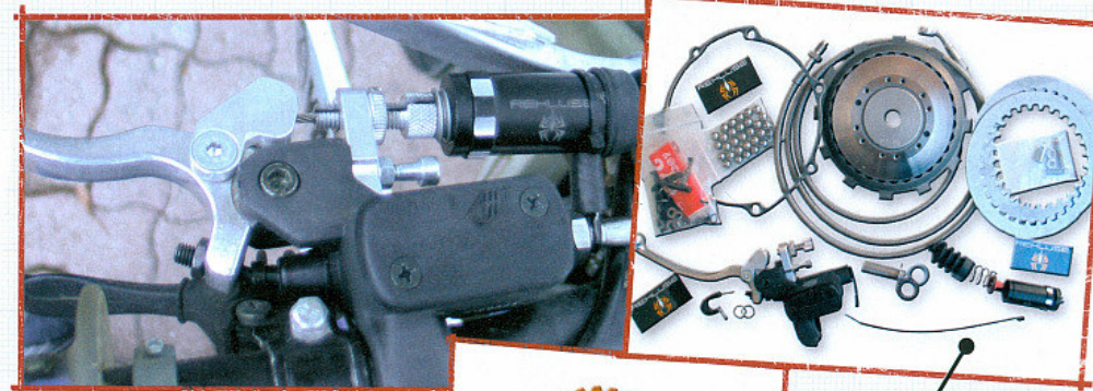
BAUTEIL, DAS FÜR DEN ANTI-HOPPING-EFFEKT ZUSTÄNDIG IST: DER REKLUSE PERCH ADJUSTER
